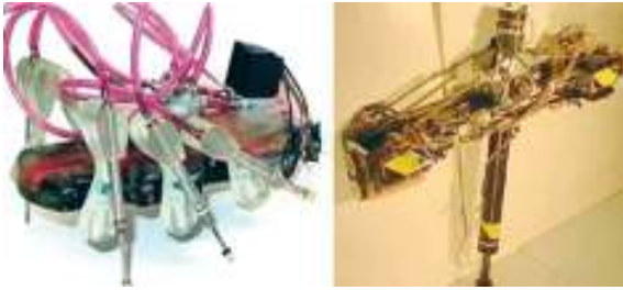
Նկ. 148. Ռոբոտներ, որոնք ստեղծվել են Ստենֆորդի համալսարանում. 1- Վեցոտանի ռոբոտ, 2-միատանի ցատկող ռոբոտ:
